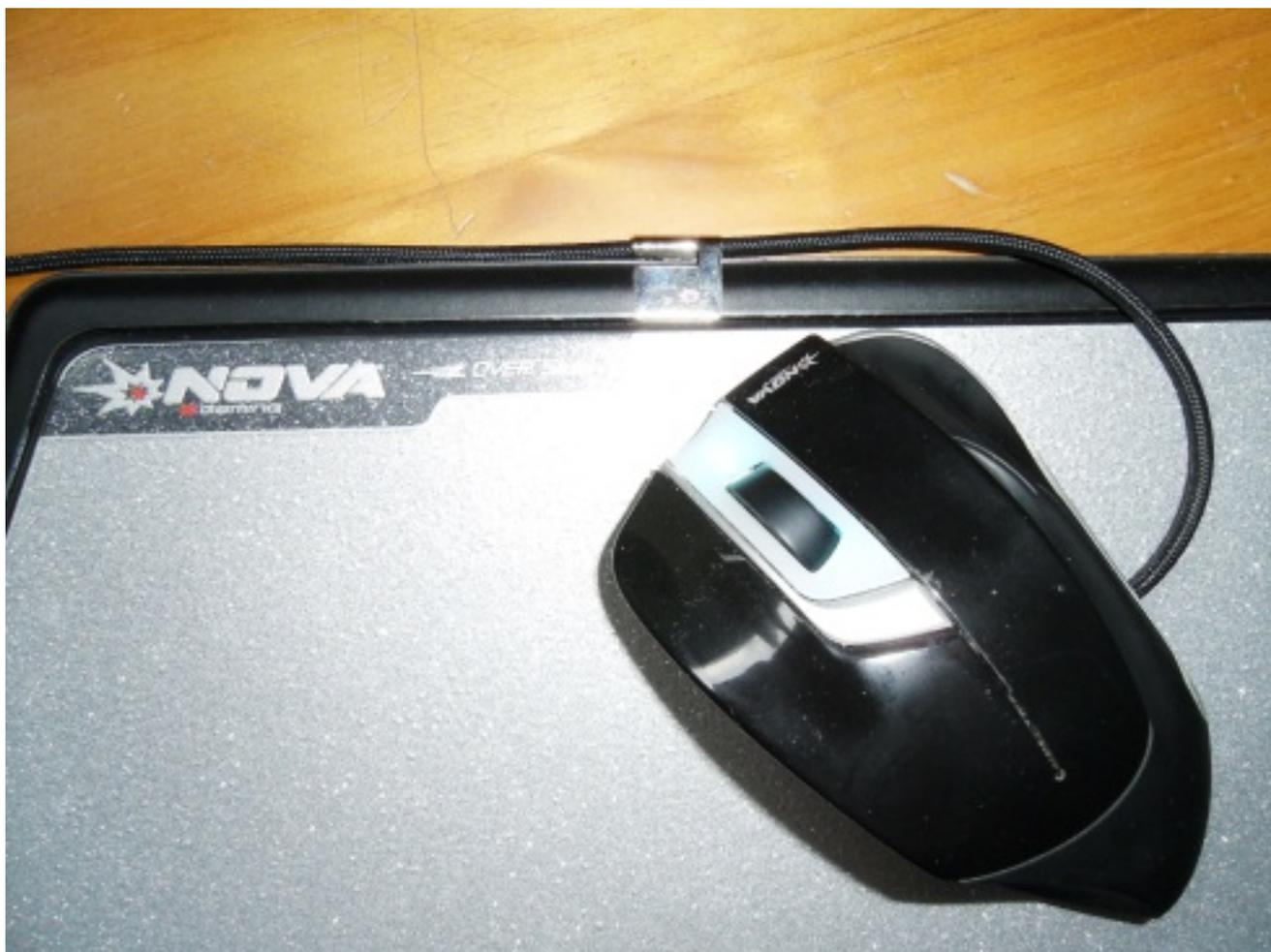
Son épaisseur de 6 MM en mousse expansée assure le confort, la planéité et l'absorption des éventuels mauvais états de surfaces ( en LAN ! ) Le verso, commun à tous les tapis NOVA est constitué de microcellules jouant le rôle de ventouse et assurant une adhésions sans faille sur toute surface.
