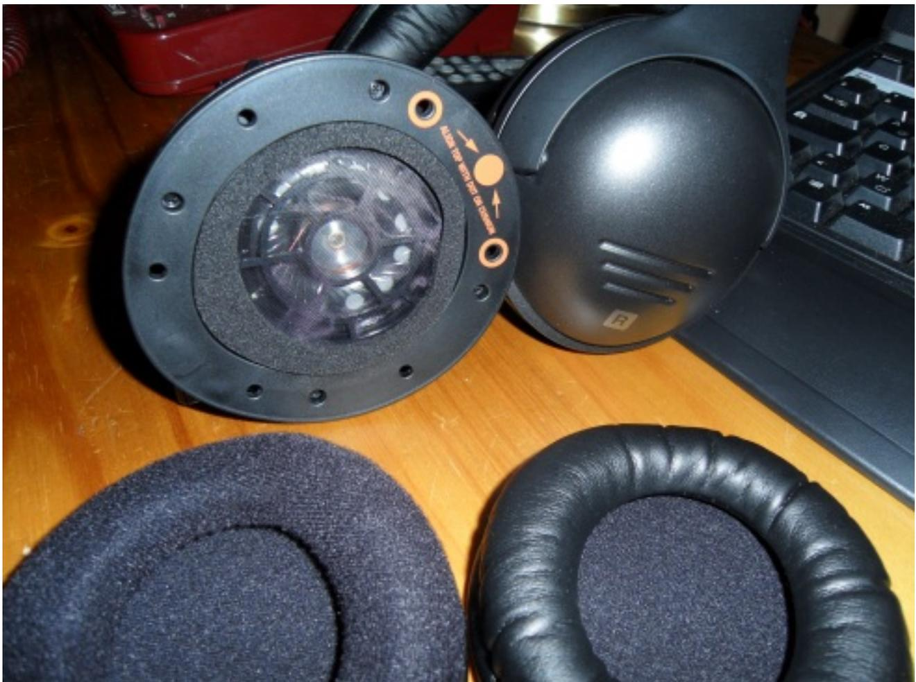
Pour changer les oreillettes, il suffira de dégrafer les coussinets et l'on pourra même ajuster la position relative des coussinets en fonction des besoins de tout un chacun, on distingue le module enceinte de bonne taille (un coaxial de 50 mm), il ne fait aucun doute que la restitution sonore doit être à la hauteur des espérances attendues par un amateur éclairé.
