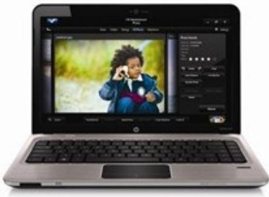
**Le HP Pavilion dm3 est votre allié divertissement et loisirs.** Il est doté d'une élégante finition métallique gravée par électrolyse. Le HP Pavilion dm3 intègre des processeurs AMD Athlon II Neo ou Turion II Neo de dernière génération ainsi qu'une carte graphique ATI Radeon HD5430 en option.
