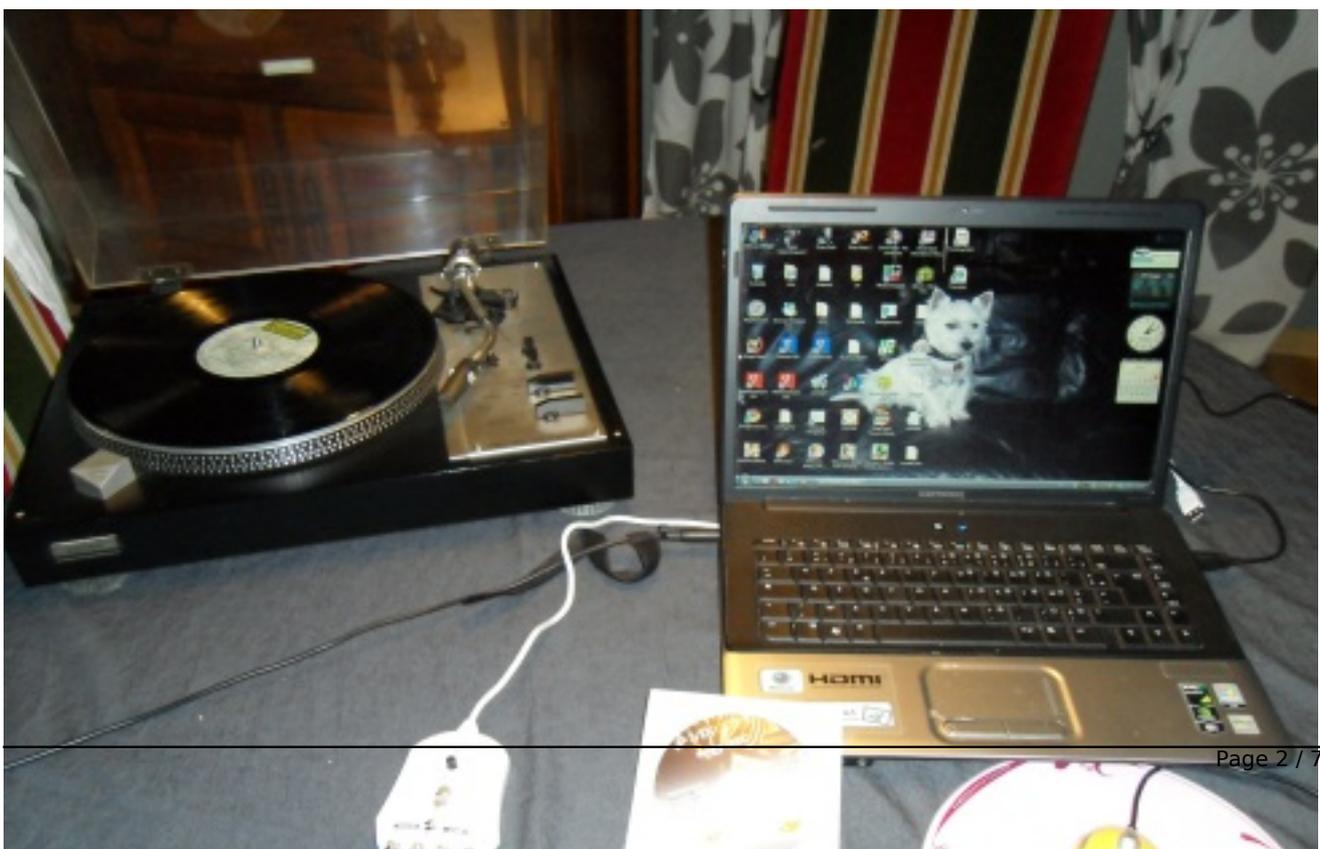
1-Brancher la connexion en RCA sur une platine vinyle, une platine CD, un lecteur de cassette audio ou une radio au canal d'entrée de l'U-RIP22, laquelle sera branchée à votre ordinateur en USB.
