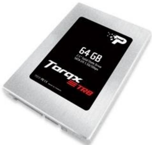
**Disponibles en capacitÃ©s** de 32 Go et de 64 Go, les disques TorqX TRB sont basÃ©s sur le contrÃ´leur le plus rÃ©cent de JMicron, le JMF616. DotÃ©s d'un cache DDR2 de 64 Mo sur le contrÃ´leur, ils offrent des vitesses allant jusqu'Ã 236 Mo/sec en lecture et jusqu'Ã 115 Mo/sec en Ã©criture. En outre, pour maintenir l'Ã©quilibre des performances durant toute leur durÃ©e de vie, ils supportent nativement la commande TRIM dans Microsoft Windows 7.
