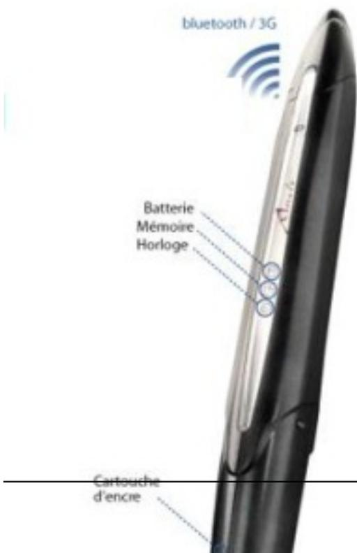
Le stylo numérique est un peu plus gros qu'un stylo normal. Il est équipé d'une mini caméra intégrée au dessus de la plume du stylo, d'un processeur, d'une mémoire et d'un système de connexion Bluetooth ou d'une interface USB.
