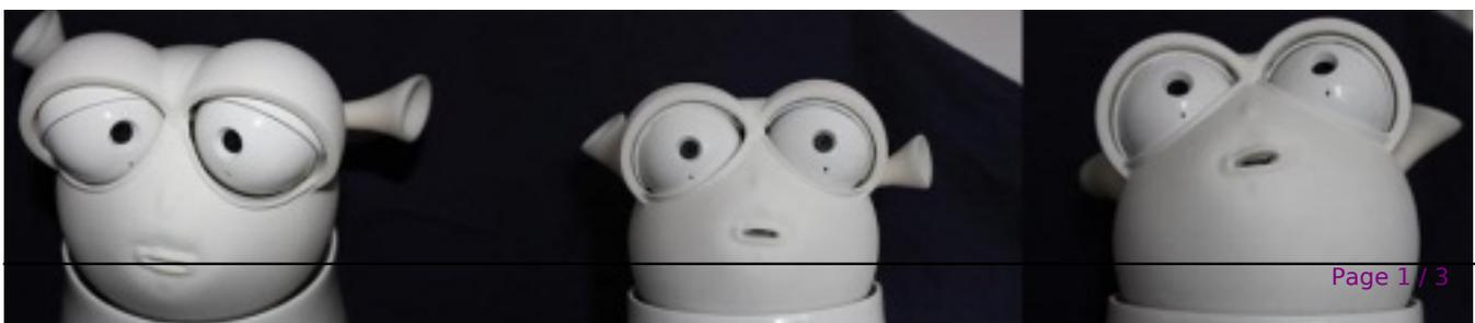
**Le corps de Reeti est un véritable ordinateur** (HD 500Go, Atom Ion dual Core 1,8 GHz, WiFi, 4 ports USB dont 2 en USB 3.0, HDMI et DVI, Ethernet Gigabit, audio 7.1 coaxiale et optique). La connectique est cachée sous le socle et un lecteur Blu-Ray / graveur DVD se dissimule dans le sac à dos. Reeti peut ainsi être utilisé comme un PC multimédia relié à un écran ou un téléviseur et contrôlé avec un clavier et une souris sans fil.
