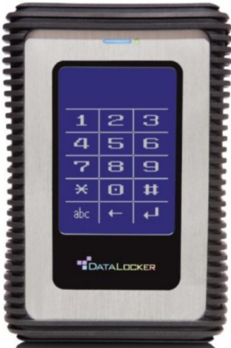
**Le Data Locker 3 est basé sur un système matériel de cryptage militaire CBC/XTS** permettant de crypter l'ensemble des données. Il est le digne successeur du Data Locker 2, dont il faut rappeler la certification FIPS 140-2, gage d'un niveau de sécurité très élevé. La procédure de remise à zéro du DataLocker a été simplifiée, puisque désormais cette fonction est accessible rapidement via une simple touche.
