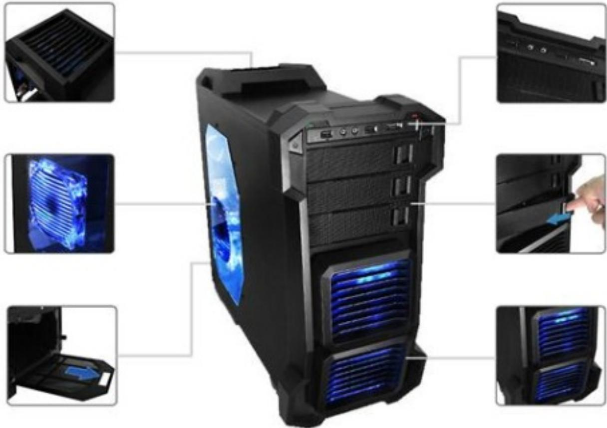
**Les slots PCI ventilés achèvent de correctement** assurer le passage de l'air à travers le boîtier. Pour les plus chevronnés le Helios autorise l'installation d'un système de refroidissement par eau.
