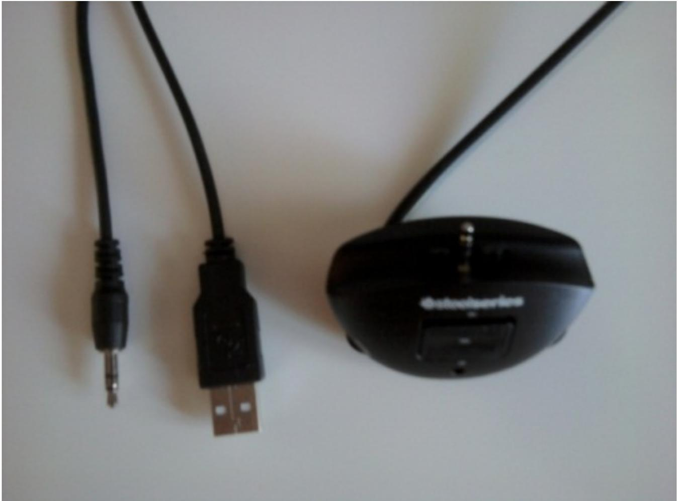
L'adaptateur AudioMixer et permet des réglages Audio en pleine partie, on peut donc couper le micro avec le bouton Micro ON/OFF, régler le niveau sonore du jeu avec la molette de réglage GAME (si vous avez connecté le diviseur RCA), de même pour le son des voix des autres joueurs, grâce à la molette VOICE.
