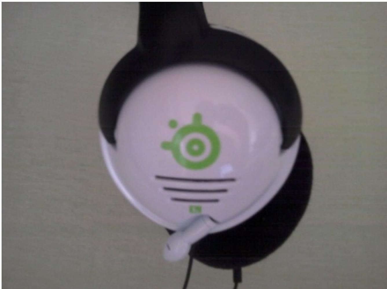
**Le 4XB contient un micro flexible et rétractable dans l'écouteur gauche**. Les coussinets sont identiques au 5XB, ils sont rembourrés et doux, et sont assez large pour ceux qui ont de grandes oreilles, les bruits extérieurs sont assourdis et ne sont plus qu'à un lointain souvenir puisque les coussinets sont bien isolant.
