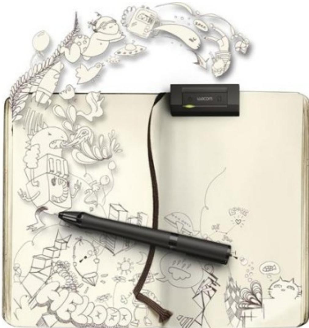
**Le récepteur peut être fixé au bord du papier ou du carnet d'esquisses** et la position peut être ajustée pour les utilisateurs gauchers ou droitiers afin que le récepteur puisse bénéficier d'une ligne de visée ininterrompue avec la pointe du stylet. Lorsque le croquis est
