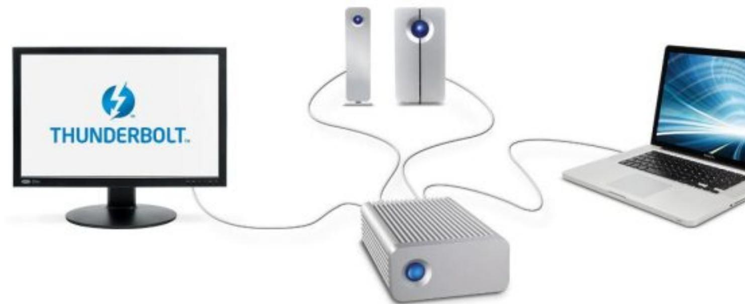
Le Hub dispose également d'un deuxième port Thunderbolt qui permet à l'utilisateur de connecter d'autres périphériques Thunderbolt. Il est donc possible de brancher 12 disques eSATA (6 x Dock, 2 x liaisons eSATA par Hub) grâce à une connexion unique sur un Mac, avec des vitesses eSATA maximales de 3 Gb/s.
