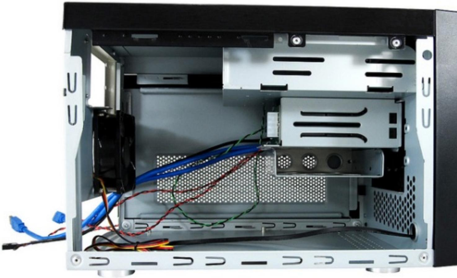
Pour permettre un bon refroidissement des composants du boîtier, des trous ont été placés juste à côté de l'emplacement des cartes graphiques. De plus un ventilateur de 80 mm est proposé en standard associé à un module de 120 mm discrètement illuminé pour assurer un flux d'air frais constant.
