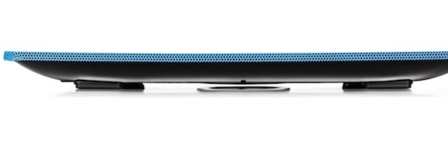
**Réalisé en métal lisse du plus bel effet, la surface supérieure du N1 est visuellement attractive.** La base est en plastique dur de haute qualité s'intégrant parfaitement à l'ensemble. Le métal doté de micro perforations, s'étend sur toute la surface supérieure et vient terminer sa course sur les bords arrondis du support. Sous cette surface, un imposant ventilateur de 180 mm assure un refroidissement optimal de votre notebook.
